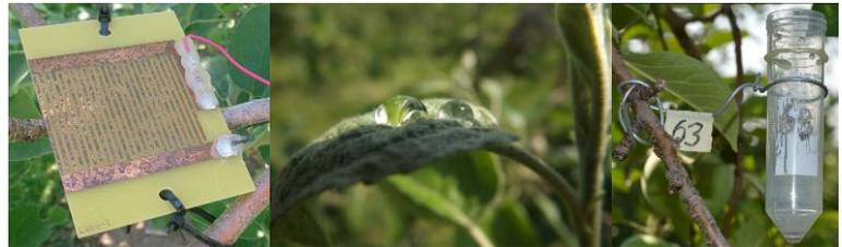
Figure 2 : Sonde électronique de mouillure (*gauche*), feuille de pommier mouillée (*milieu*) et mini-pluviomètre (*droite*) employés dans l'étude de la variabilité spatiale de la durée de mouillure du feuillage.
