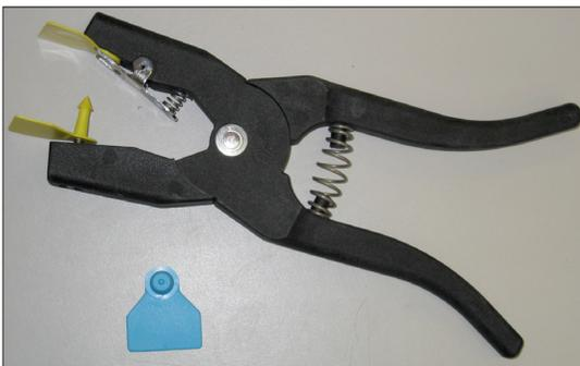
6. L'utilisation d'identifiants externes réduit considérablement les stress induits aux géniteurs lors de leur sélection. Exemple d'épinglette et de pince pour les mettre en place.
