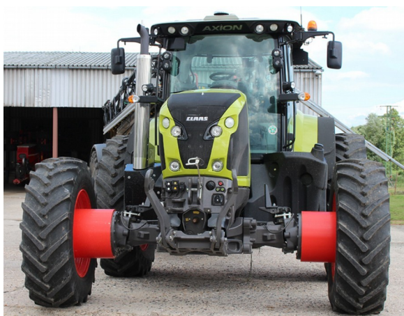
Figure 4. Élargissement de la largeur de roulement à l'aide de cannelles (en rouge) (grainews.ca).
