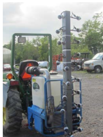
Pulvérisateur électrostatique de marque BSL
