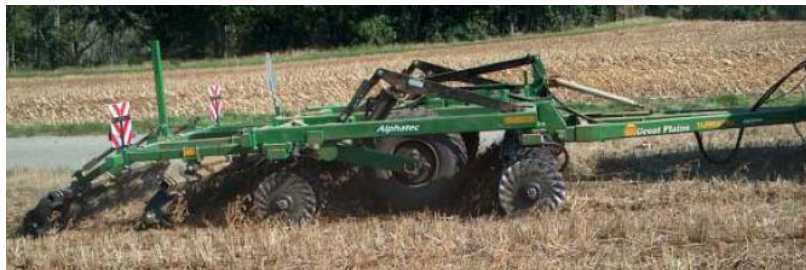
Figure 2. Herse Turbo-till pour réaliser l'incorporation rapide (photo : Great Plains)
