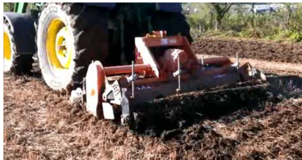
Figure 5. Utilisation d'un rotoculteur pour l'incorporation rapide des lisiers (photo : Catherine Bossé)
