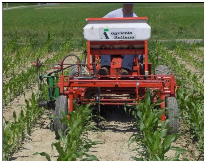
Figure 6. Épandeur d'azote en postlevée à deux rangs (Photo : IRDA)
