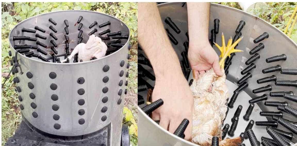
Photo 1.8 Appareil servant à l'enlèvement des plumes (plumeuse)
