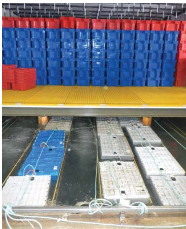
Nouvelle unité de contention installée au-dessus d'un vivier traditionnel.
