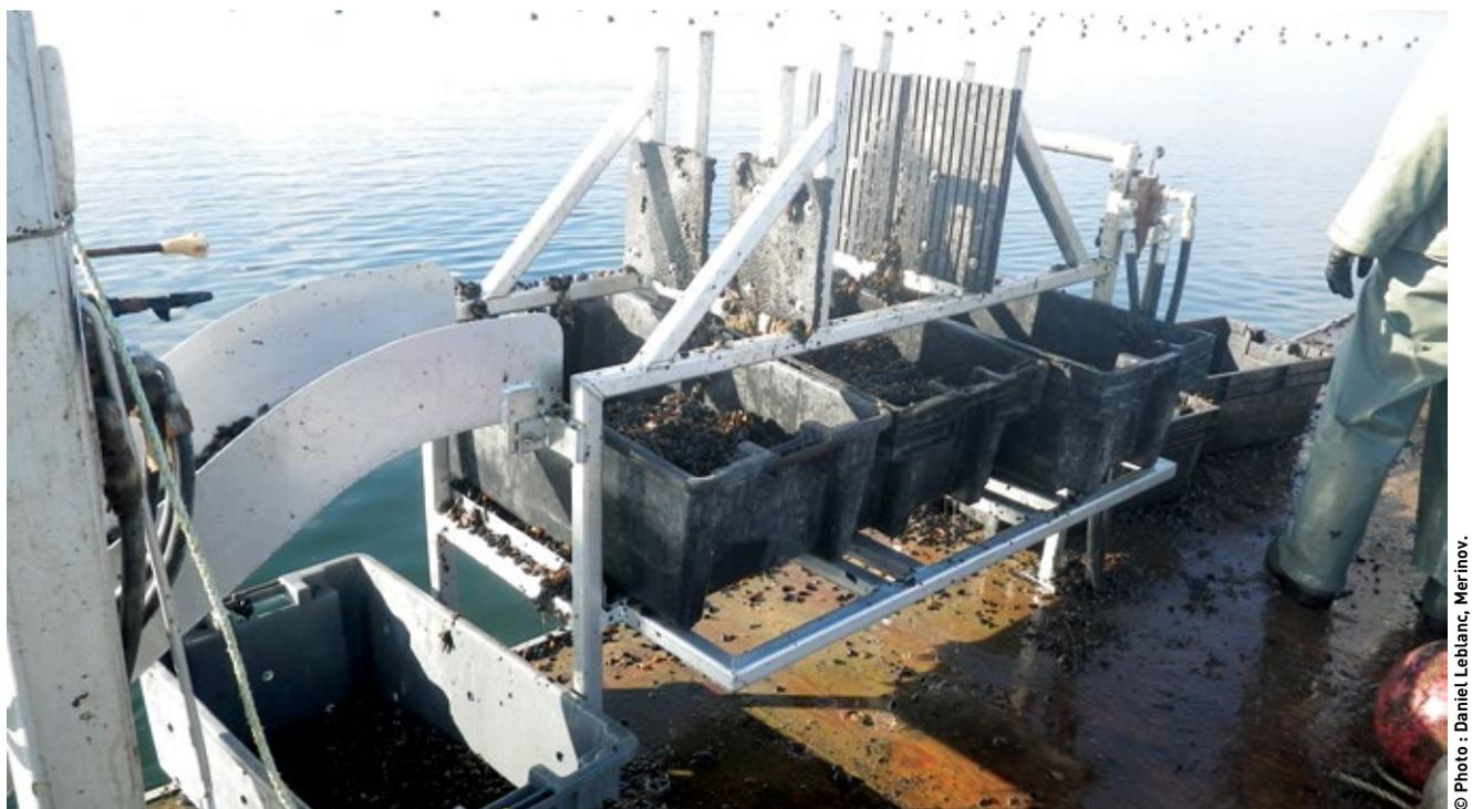
Nouveau système de dégrappage du naissain fait de panneaux souples fixés à une structure métallique.
