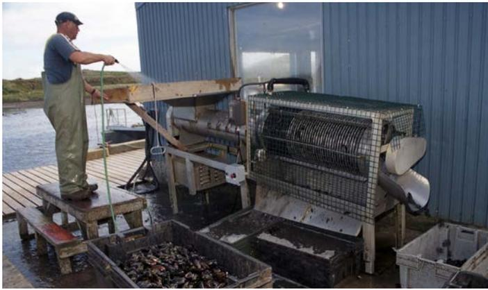
Figure 10 — Dégrappeuse-trieuse
