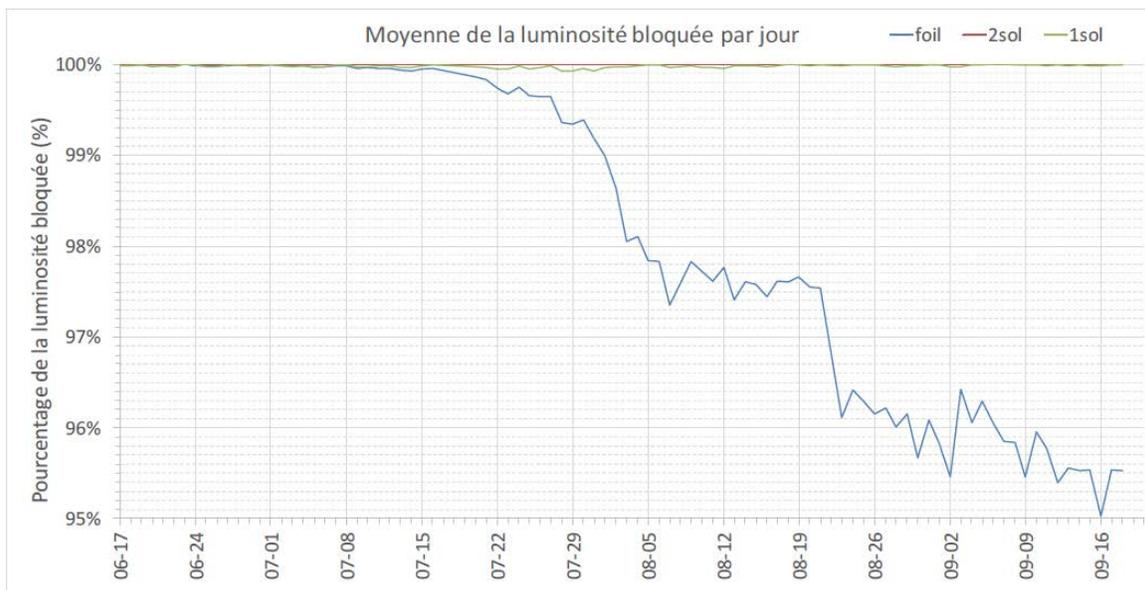
Figure 2. Opacité mesurée des différents matériaux à l'essai.
