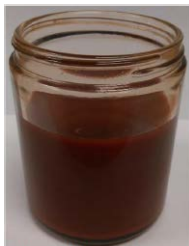
Figure 1 : Échantillon d'huile pyrolytique à haut potentiel énergétique pour le remplacement du mazout n° 2 dans les systèmes de chauffage
