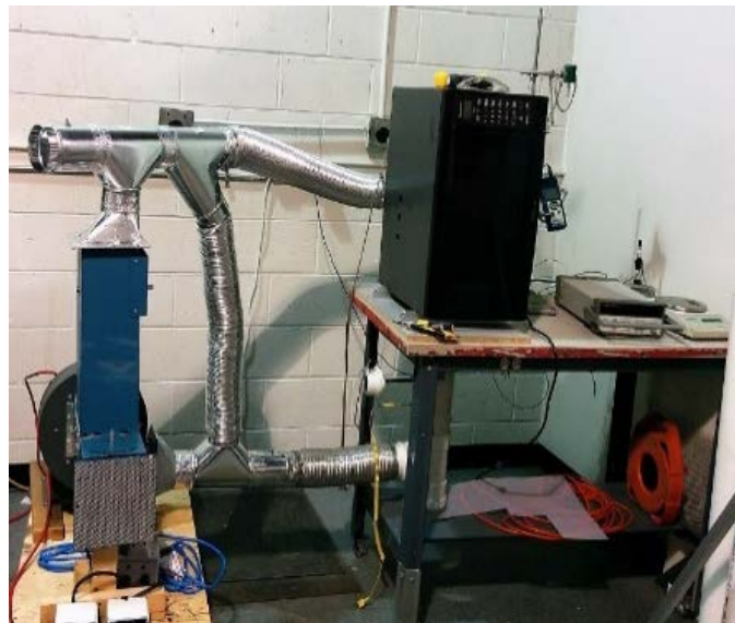
Figure 1: Photo du séchoir à lit fluidisé à air chaud et micro-ondes utilisé pour le séchage des résidus de légumes.
