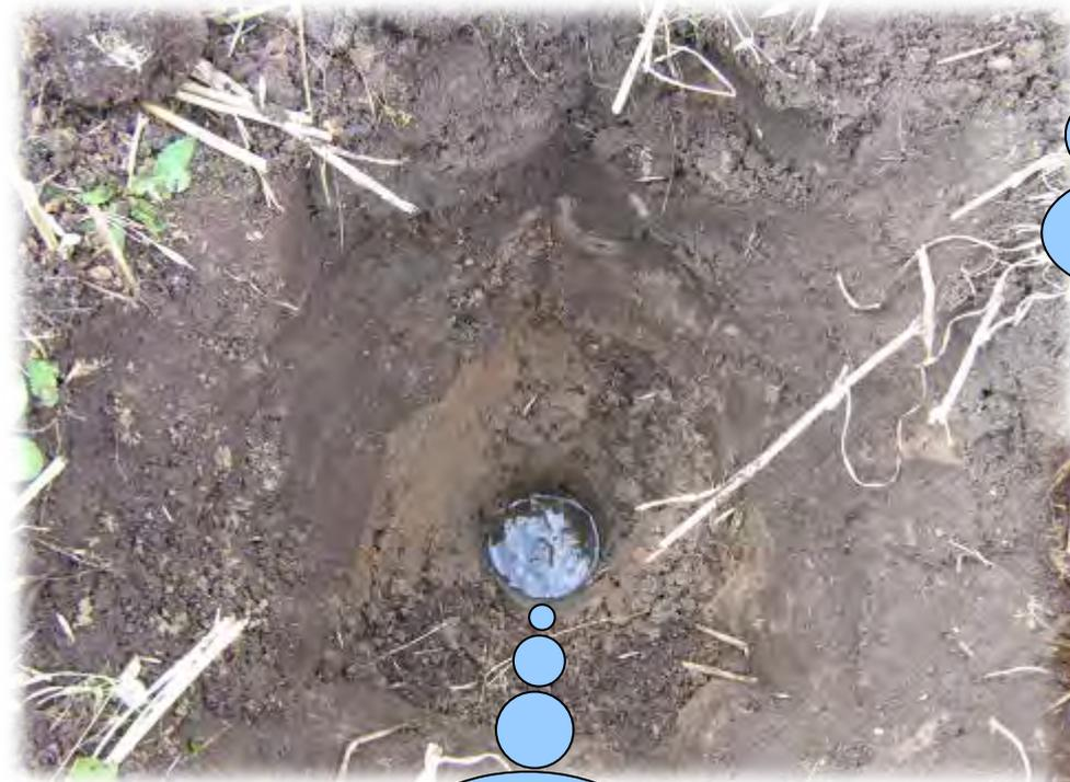
Le niveau d'eau provient du haut, c'est l'écoulement hypodermique ou une nappe perchée
