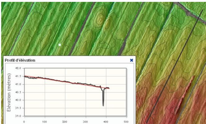
Tracez des profils pour extraire des données d'élévation ainsi que la pente du terrain.
