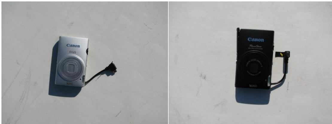
Les caméras ont été modifiées par le fabricant pour les synchroniser avec le drone. Le cerveau du drone commande la prise de photos aériennes lorsque le positionnement pour chaque photo est atteint. Le moteur du drone est coupé le temps de la prise de photo afin de réduire les vibrations.
