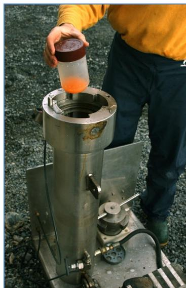
Figure 7. Appareil utilisé pour administrer aux œufs le choc de pression nécessaire à la production des embryons triploïdes (3N).
